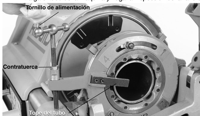
Figura 3 – Corte de una ranura en el tubo
