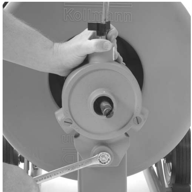
Figura 16 – Extracción del perno de la AUTOFEED
