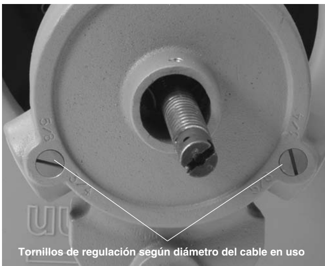
Figura 9 – Tornillos de regulación en la AUTOFEED
