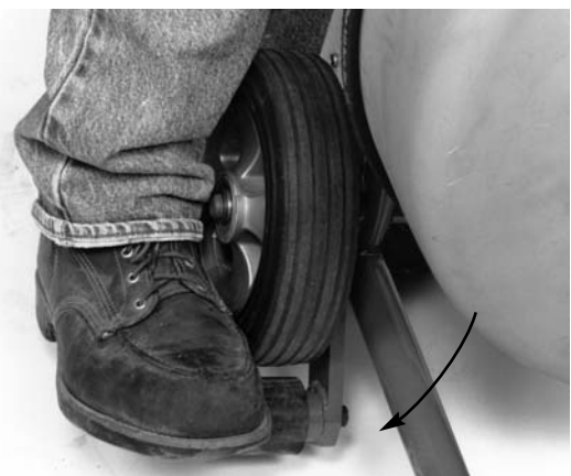
Figura 11 – Descenso de los pies de apoyo
