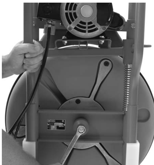
Figure 18 – Retrait du boulon du tambour
