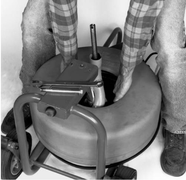
Figure 19 – Dépose du tambour
