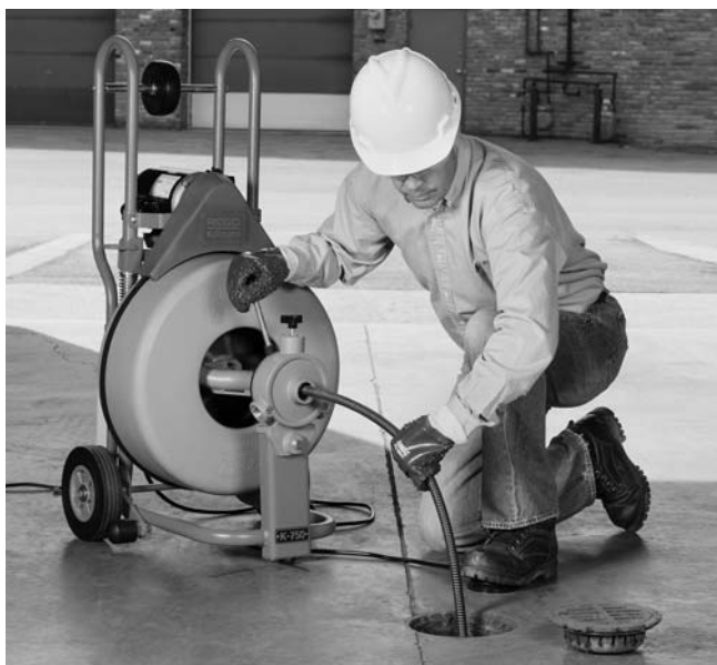
Figure 14 – Utilisation du K-750 avec AUTOFEED
