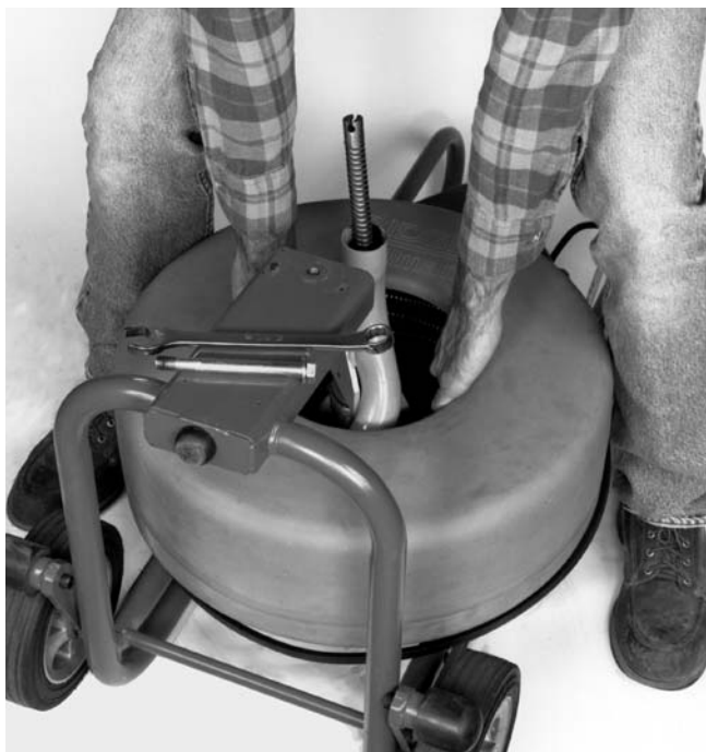
Figura 19 – Extracción del tambor
