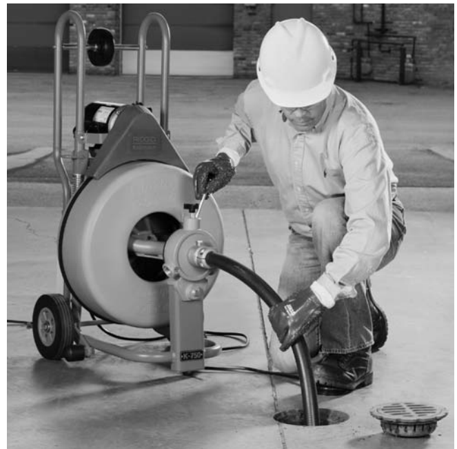
Figura 15 – Empleo de una limpiadora con manguera-guía delantera
