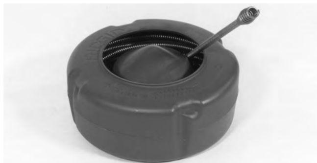
Рис. 16 – При заправке троса во внутренний барабан наматывайте трос ПО ЧАСОВОЙ СТРЕЛКЕ.
