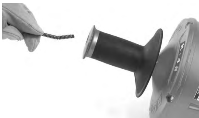
Рис. 17 – Заправка троса без замены внутреннего барабана
