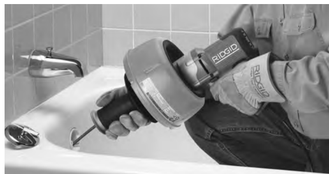
Рис. 9 – Протолкните трос дальше в канализационную трубу
