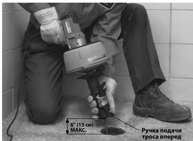
Рис. 10 – Подача троса с помощью устройства AUTOFEED
