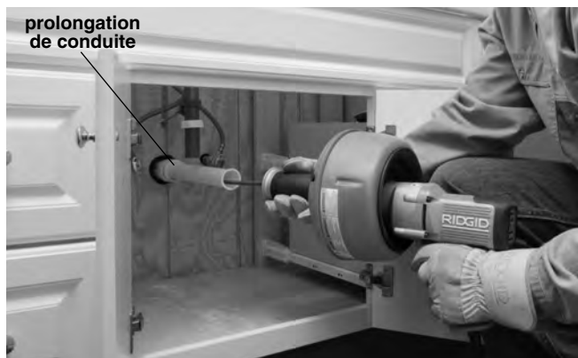
Figure 6 – Exemple d'un point d'accès prolongé permettant de respecter une distance maximale de 6" (15 cm) par rapport à la sortie du tambour
