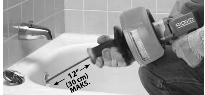
Şekil 8 - Kabloyu Mandrenle Kavramak için Tutamağı Makaraya Yaklaştırın
