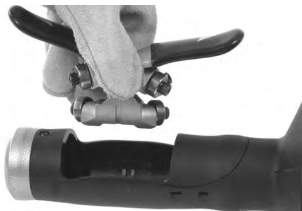
Рис. 12В – Снятие с корпуса устройства автоподачи AUTOFEED
