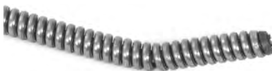
Figure 15 – Plissage de l'embout de câble
