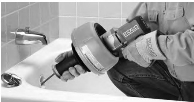
Figure 9 – Pousser le câble dans la conduite
