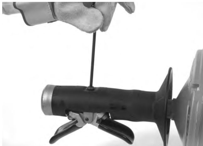
Рис. 12А – Отворачивание винта крепления устройства автоподачи AUTOFEED
