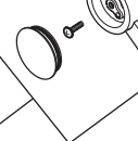
RP62959▲ Temperature Knob, Cover & Screw Perilla de la Temperatura, Cubierta y Tornillo Poignée de Réglage de Température et Vis
