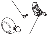
RP34358▲ Temperature Knob and Cover Perilla de la Temperatura y Cubierta Poignée de Réglage de Température
