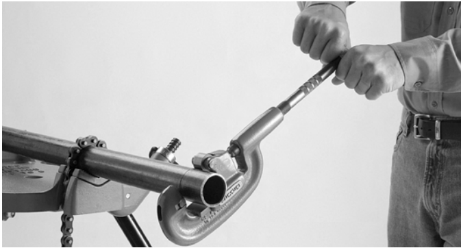
Figure 3 – Coupe de l'extrémité du tuyau
