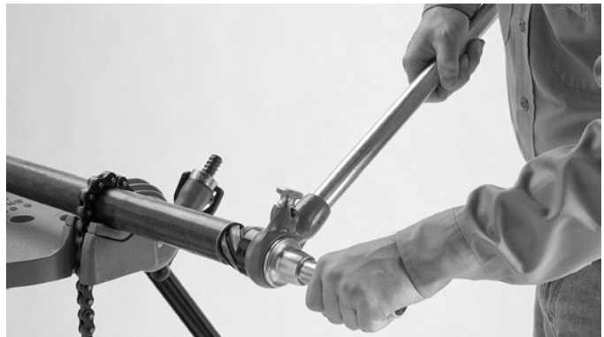
Figure 4 – Escariado del extremo del tubo
