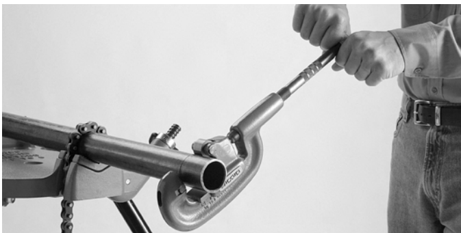
Figure 3 – Corte del extremo de un tubo
