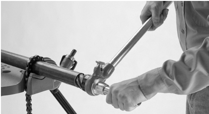
Figure 4 – Alésage de l'extrémité du tuyau
