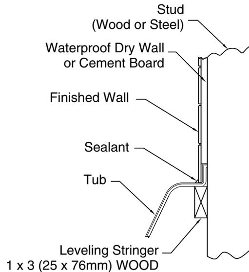
**SECURE THE BATH TO THE STUDS AS SHOWN FOR WOOD OR STEEL STUD CONSTRUCTION.**
